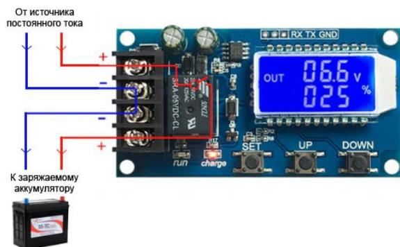
Подключаются источник питания и аккумулятор к устройству с помощью клеммника.
