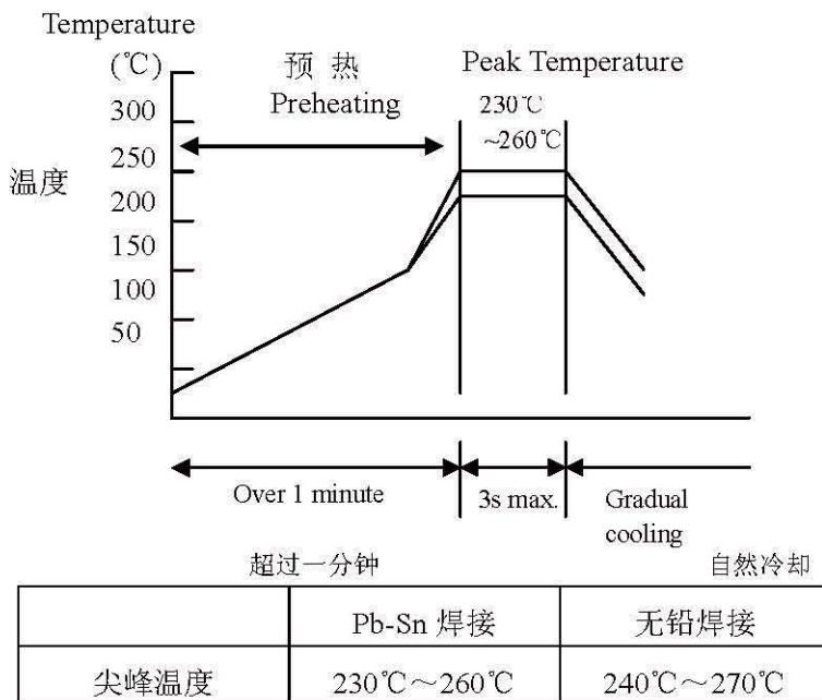
在预热时, 请将焊接温度与芯片表面温度之间的温差维持在  $T \leq 150^{\circ}\text{C}$ 。
