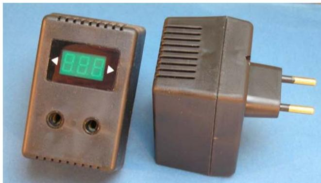
Автомат защиты предназначен для автоматического выключения любой бытовой аппаратуры, суммарная потребляемая мощность которой не превышает 2,5 киловатта, если напряжение в электросети превышает верхний предел отключения, заданный в настройках прибора или понижается ниже заданного нижнего предела отключения и автоматического включения, если напряжение
